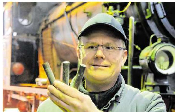
Werkstattchef und zweiter Vereinsvorsitzender Torben Kluwe mit Stehbolzen aus der Lok. 96 Bolzen müssen erneuert werden, das kostet rund 60 Euro pro Stück.
